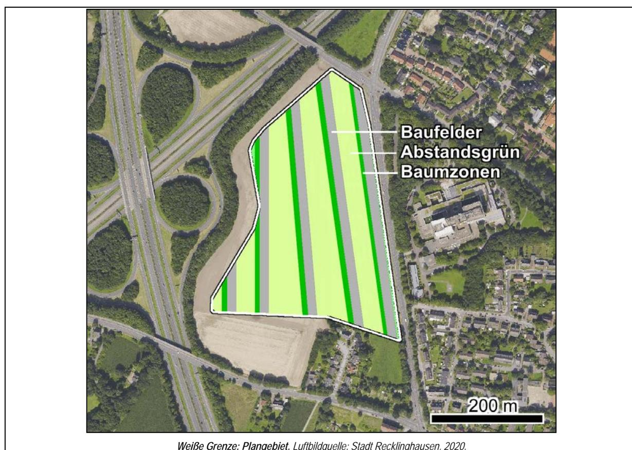
**Abb. 41: Plangebiet GH: Empfehlungen zur Lageorientierung von Gebäuden und Bäumen (schematisch).**
