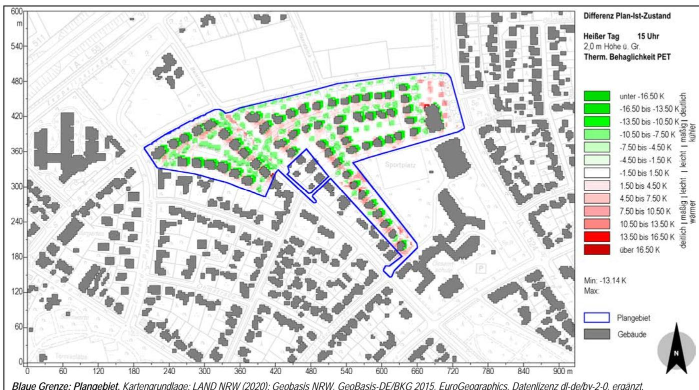
**Abb. 29: Plangebiet W3: Differenzen der thermischen Behaglichkeit in 2 m ü. Gr. um 15 Uhr eines heißen Tages für den Plan-Zustand im Vergleich zum Ist-Zustand.**
