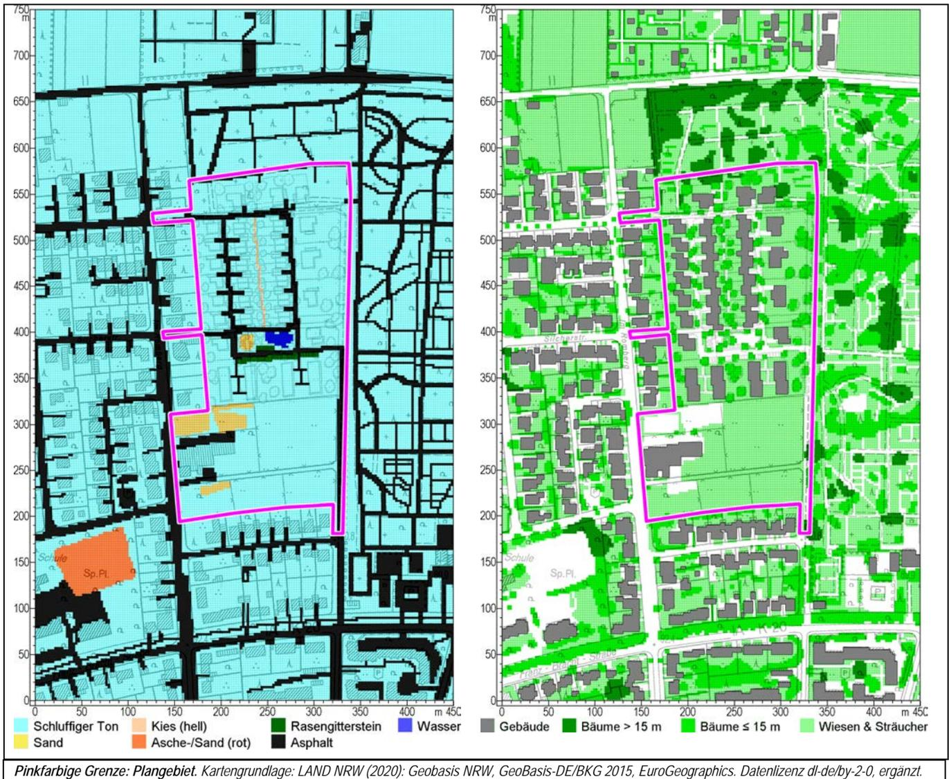
**Abb. A 4: Plangebiet W2: Digitale Modelle der Böden und Oberflächen (links) sowie der Gebäude und Vegetation (rechts) für das Klimamodell für den klimaoptimierten Planentwurf.**
