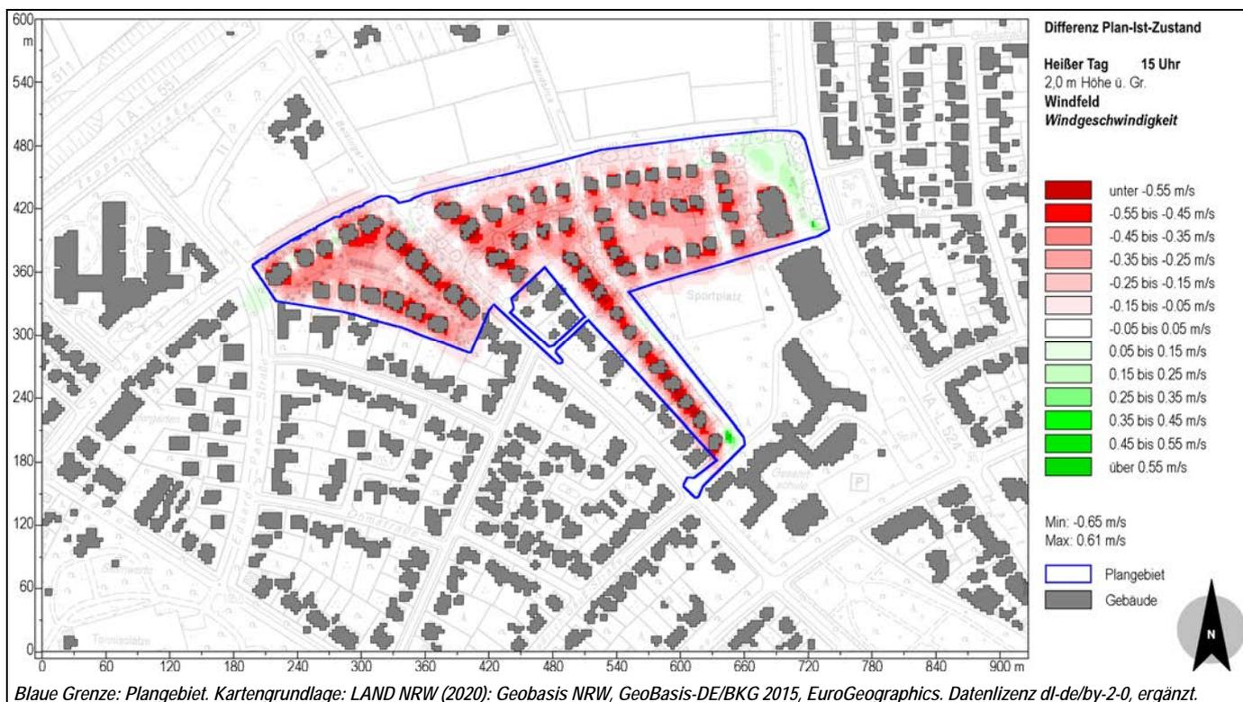
**Abb. 26: Plangebiet W3: Differenzen der Windgeschwindigkeit in 2 m ü. Gr. eines heißen Tages für den Plan-Zustand im Vergleich zum Ist-Zustand.**
