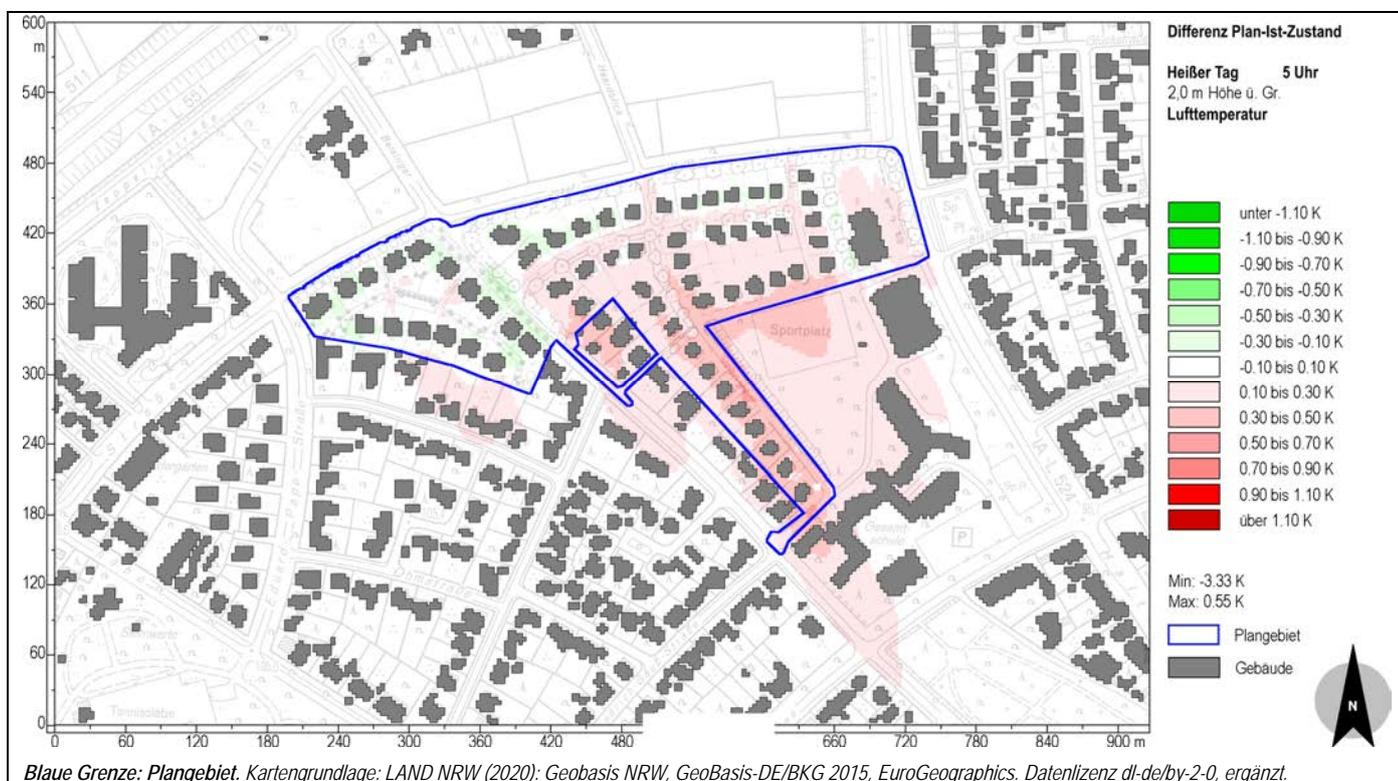
**Abb. 32: Plangebiet W3: Differenzen der Lufttemperatur in 2 m ü. Gr. um 5 Uhr eines heißen Tages für den Plan-Zustand im Vergleich zum Ist-Zustand.**
