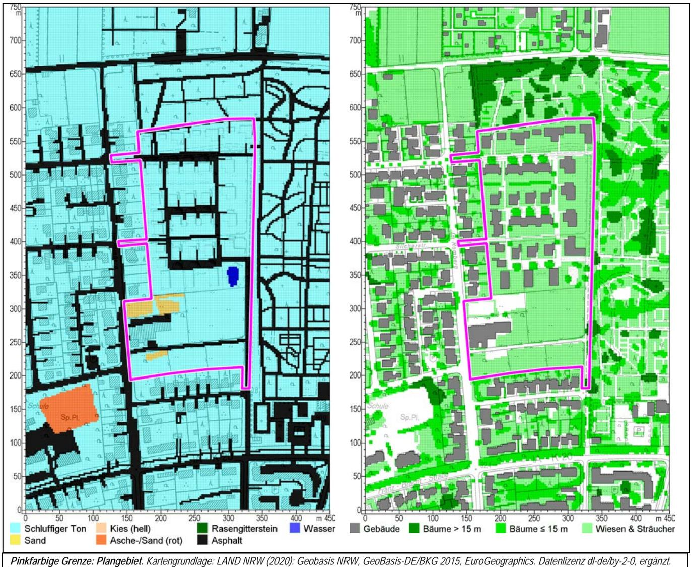
**Abb. A 3: Plangebiet W2: Digitale Modelle der Böden und Oberflächen (links) sowie der Gebäude und Vegetation (rechts) für das Klimamodell für den ersten Planentwurf.**
