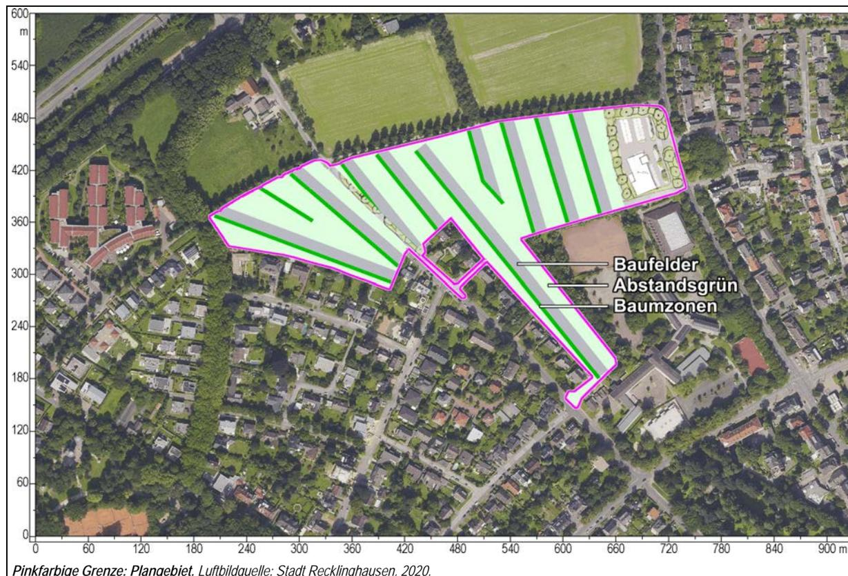
**Abb. 37: Plangebiet W3: Empfehlung zur Lageorientierung von Gebäuden und Bäumen (schematisch).**
