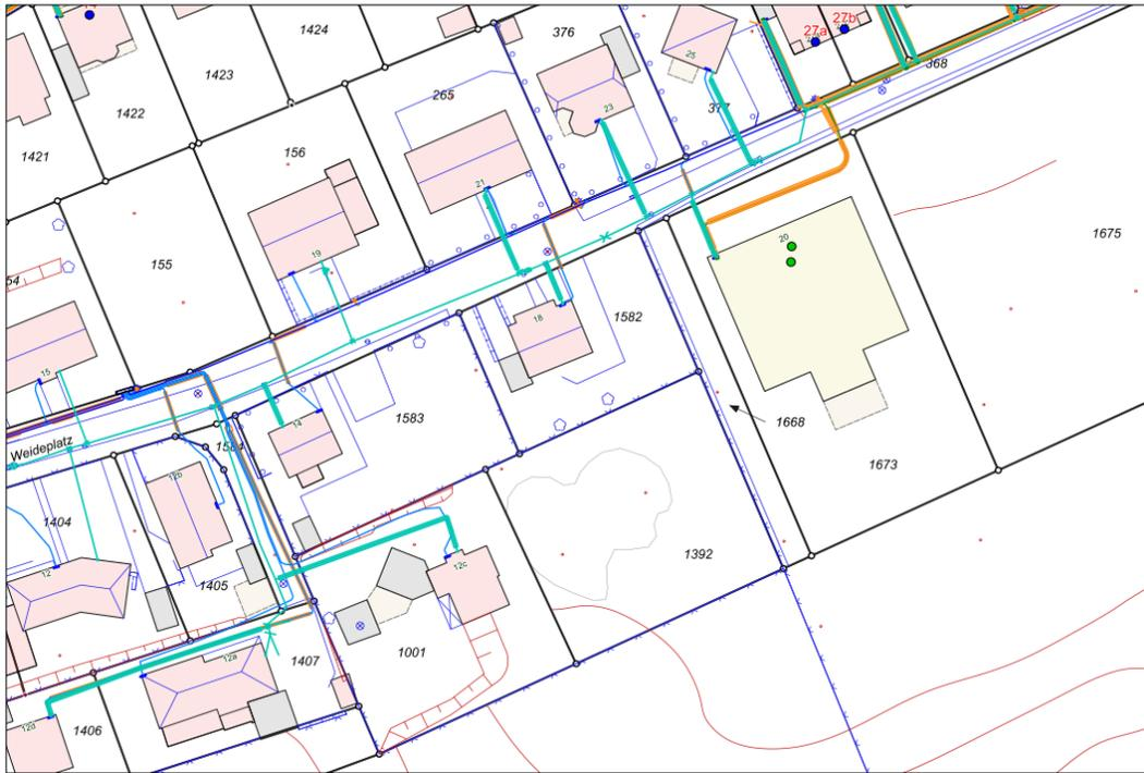
**Abb. 3: Vorhandene Wasser-, Gas-, und Stromleitungen**
