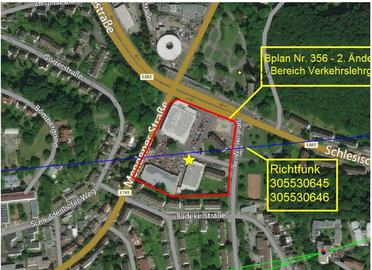
Die farbigen Linien verstehen sich als Punkt-zu-Punkt-Richtfunkverbindungen der Telefónica Germany GmbH & Co. OHG. Das Plangebiet ist im Bild mit einer dicken roten Linie eingezeichnet. Die Linien in Magenta haben für Sie keine Relevanz.
