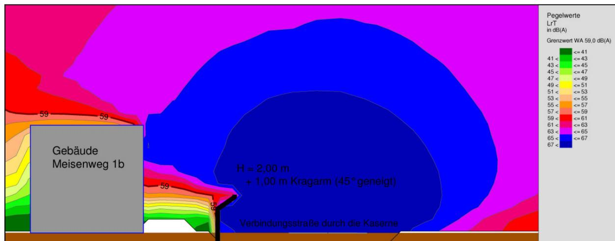
Abbildung 9: Schnittlärmkarte des Gebäudes Meisenweg 1b mit einer Wandhöhe von 2,00 bzw. 3,00 m
