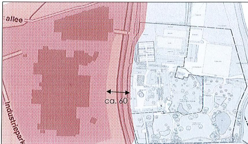
**Abb. 8:** Gebiet (rot), in dem der Immissions-Toleranzwert  $1,6 \text{ kW/m}^2$  (Personen) nicht erreicht wird. Annahme dabei ist ein Brand von Ethanol an jeder möglichen Stelle des Betriebsgeländes; das Gebiet erstreckt sich daher um ca. 60 m über die Grenzen des Betriebsgeländes hinaus.
