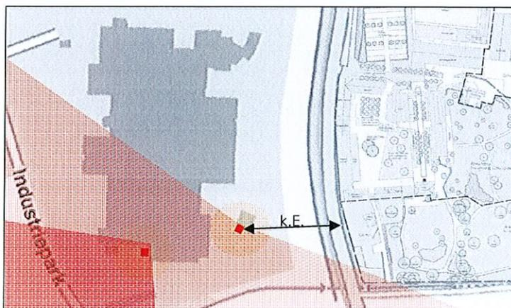
**Abb. 3:** Bereiche, die im Falle eines Trümmerflugs (rot) oder eines Feuerballs (gelb) betroffen sein können. Kürzeste Entfernung (k.E.) zwischen nächstgelegendem Lager und Sondergebiet: ca. 95 m
