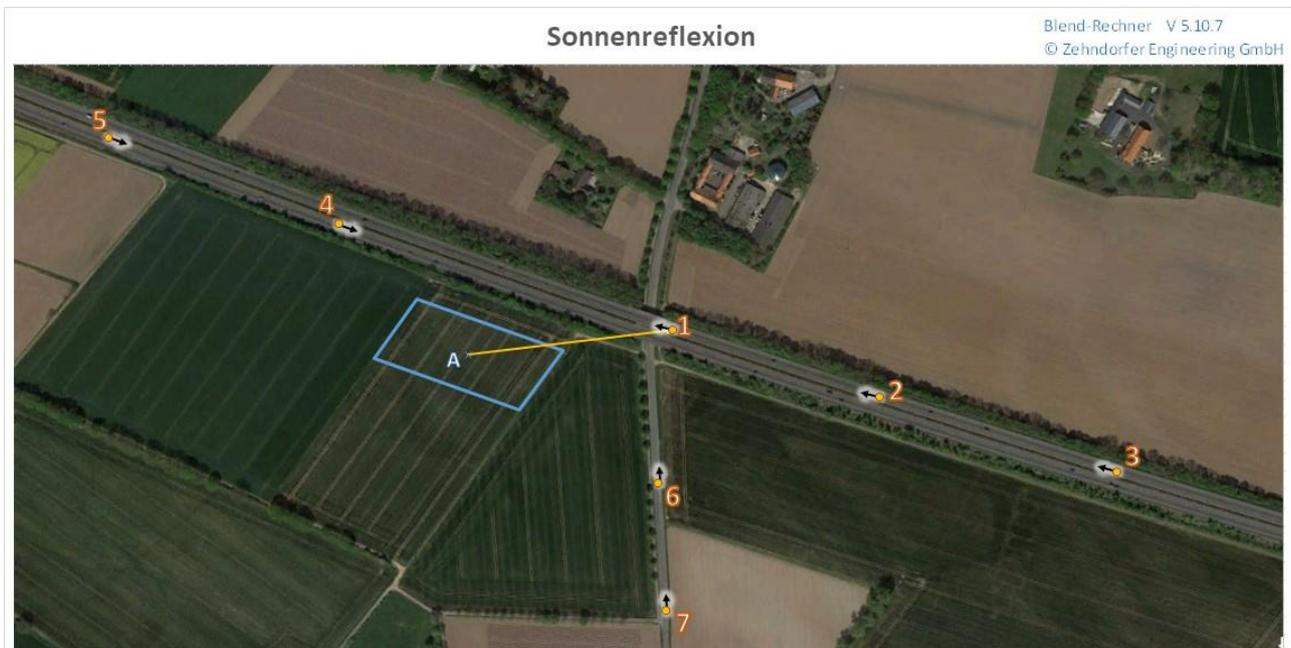
Abbildung 5 zeigt die Lage der Immissionspunkte (IP) und des PV-Feldes. Die Immissionspunkte wurden unter dem Kriterium ausgewählt, dass eine Sichtverbindung zur Vorderseite der PV-Module gegeben sein muss.
