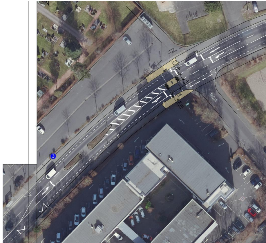
Abbildung 5-4: Fußgänger-LSA mit abgesetztem Linksabbieger (Lösung 3a)
