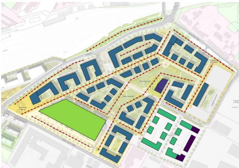
Abbildung 4 Mögliche Positionierung der Sondenbohrungen im Baugebiet
