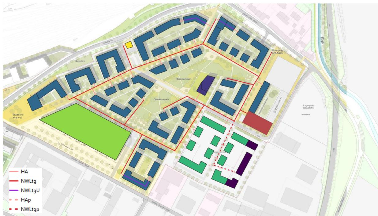
Abbildung 5 Trassenverlauf Nahwärmenetz mit Heizzentrale im Quartier
