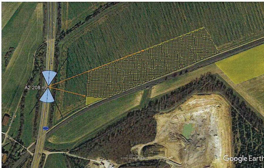
Abbildung 18: Vergleich Sichtfeld Fahrzeugführer für Punkt A2 mit Grenzvektoren in Richtung Module
