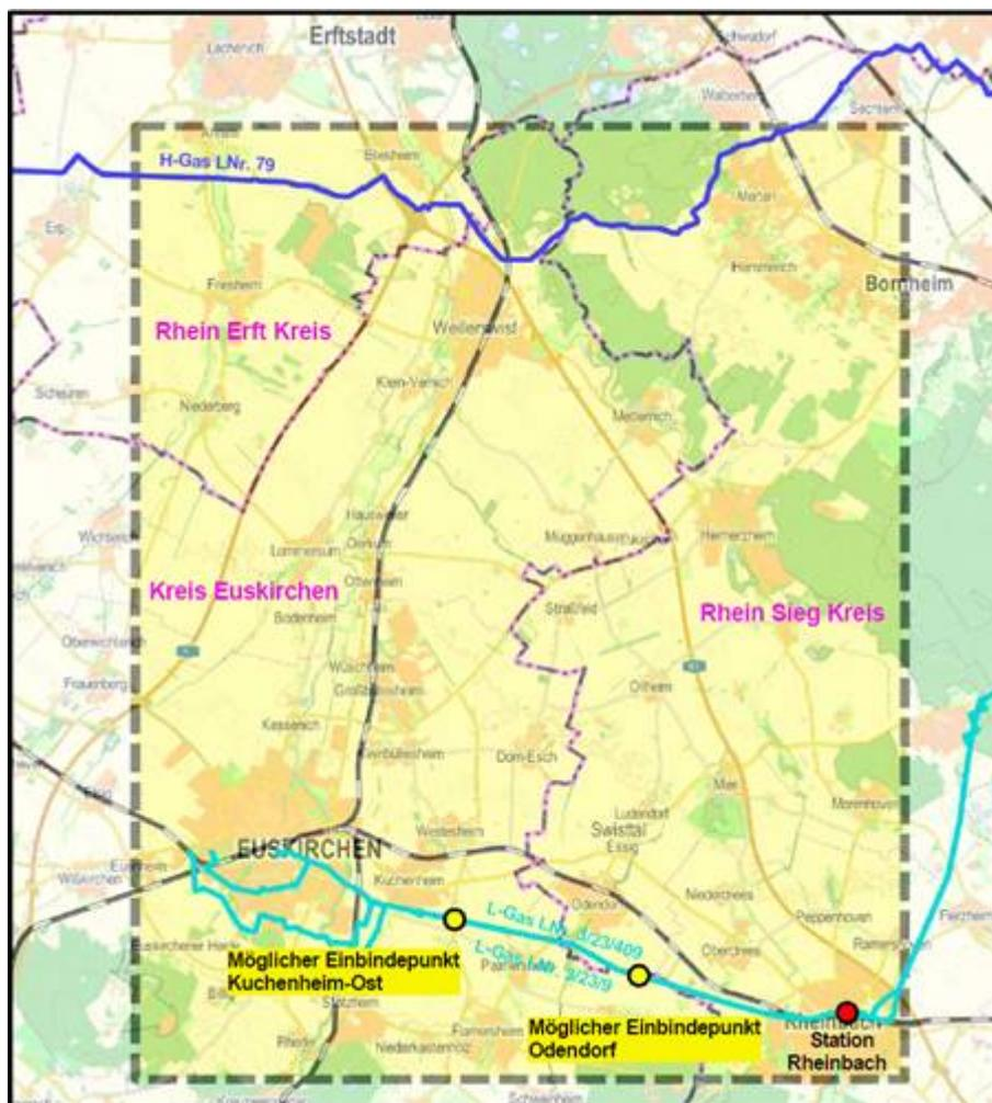
Als Untersuchungsrau ist im Rahmen des Scopings eine Fläche identifiziert worden, die zwischen der existierenden H-Gas Leitung Nr. 79 und den L-Gas Leitungen 3/23/9 und 3/23/409 liegt und die genannten Punkte bei Kuchenheim und Oberdrees umfasst.
