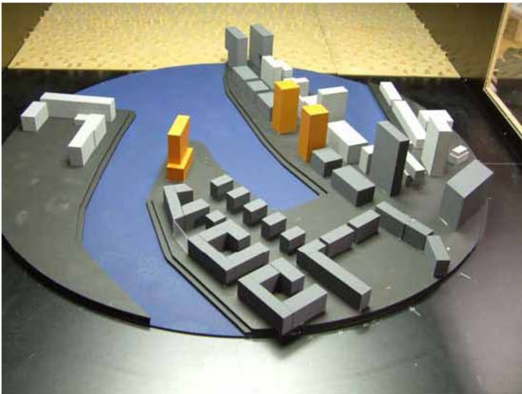
Abb. 2.2 Windkanalmodell, Planzustand (der Bebauungsplan für das Gebiet der Kesselstraße wurde mitberücksichtigt)
