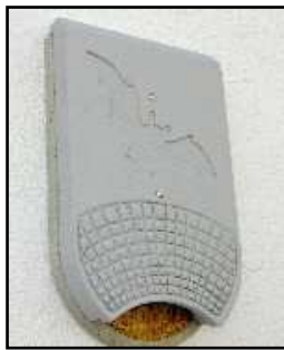
Abb. 2: Schwegler Fledermaus-Fassadenquartier 1FQ ist aus witterungsbeständigem und atmungsaktivem Holzbeton gefertigt. Das Fassadenquartier hat eine Größe von Höhe 60 x Breite 35 x Tiefe 9 cm und ist als Spaltenquartier geeignet. Die Befestigung erfolgt mit vier Schrauben. (Quelle: SCHWEGLER Vogel- und Naturschutzprodukte GmbH)
