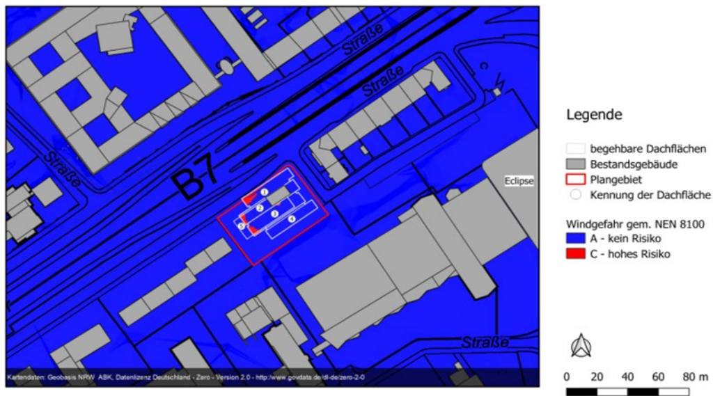
Abb. 2.2: Windgefahr gem. NEN 8100 im Planfall in einer Auswerthöhe von 1,5 m über Grund oder begehbaren Dachflächen.
