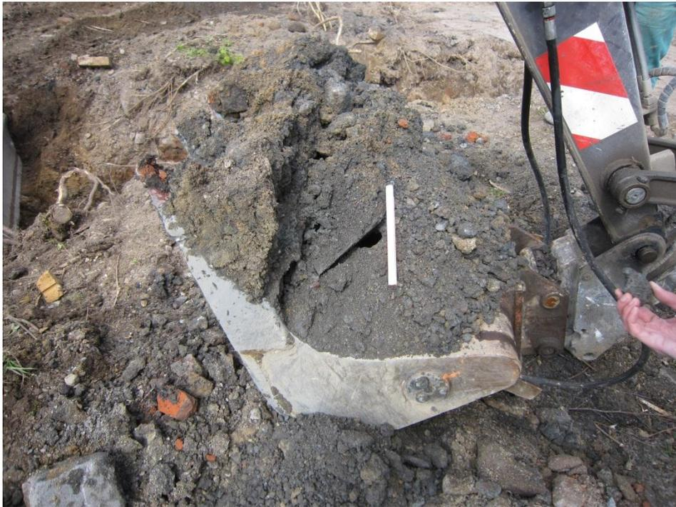
**Abbildung 6: Bindiger Boden Schurf X 2 aus Horizont 3**
