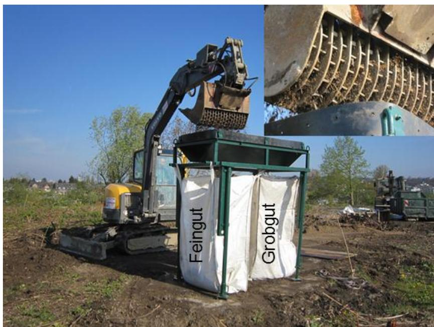
**Abbildung 2: Mobiler Bagger mit Siebschaufel**
