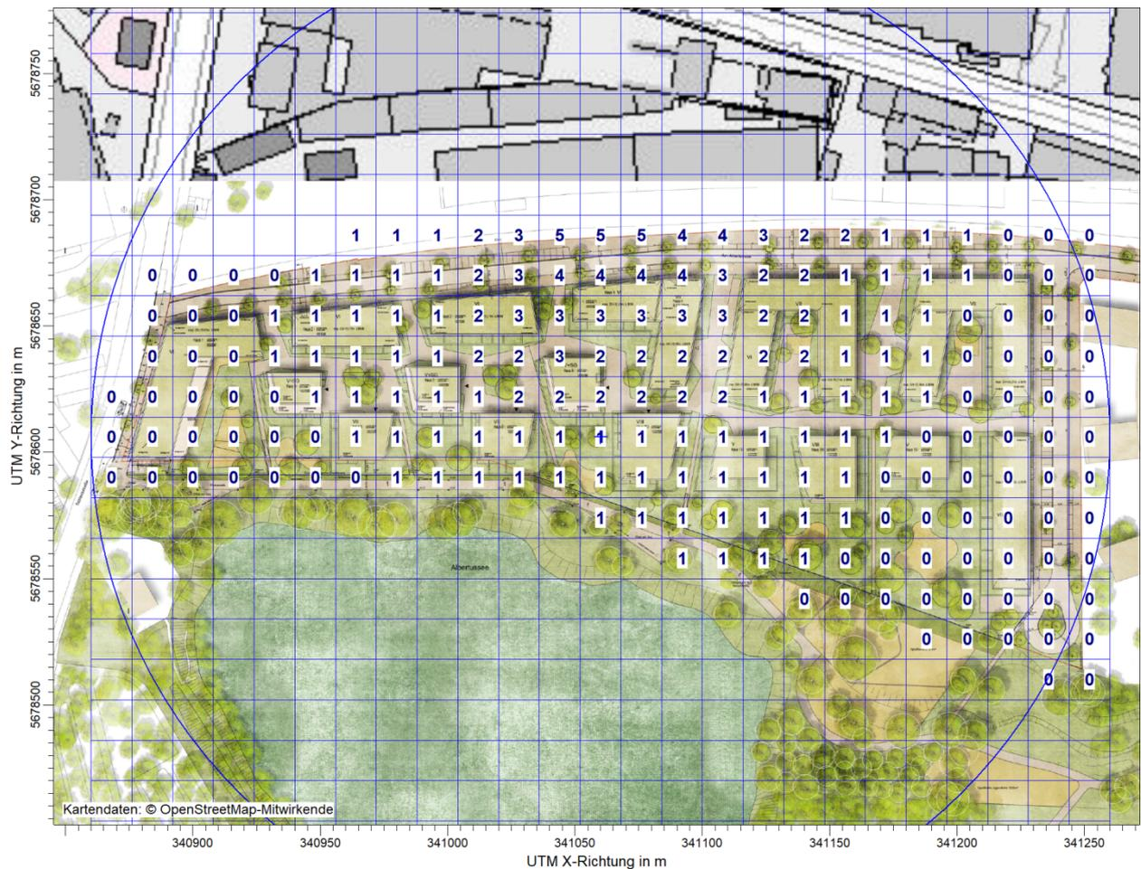
Abbildung 3: Geruchsstundenhäufigkeit im Bereich des Plangebietes, hervorgerufen durch den Betrieb der Lackieranlage der Kfz-Werkstatt (genehmigter Zustand) in %, Seitenlänge: 16 m
