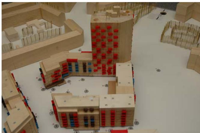
Bild 5.5: Windkomfort an Bauteil 9 Bild 5.6: Photo des Windkanalmodells für das Bauteil 9
