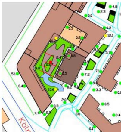
Bild 5.1: Windkomfort zwischen den Bauteilen 1 bis 4
