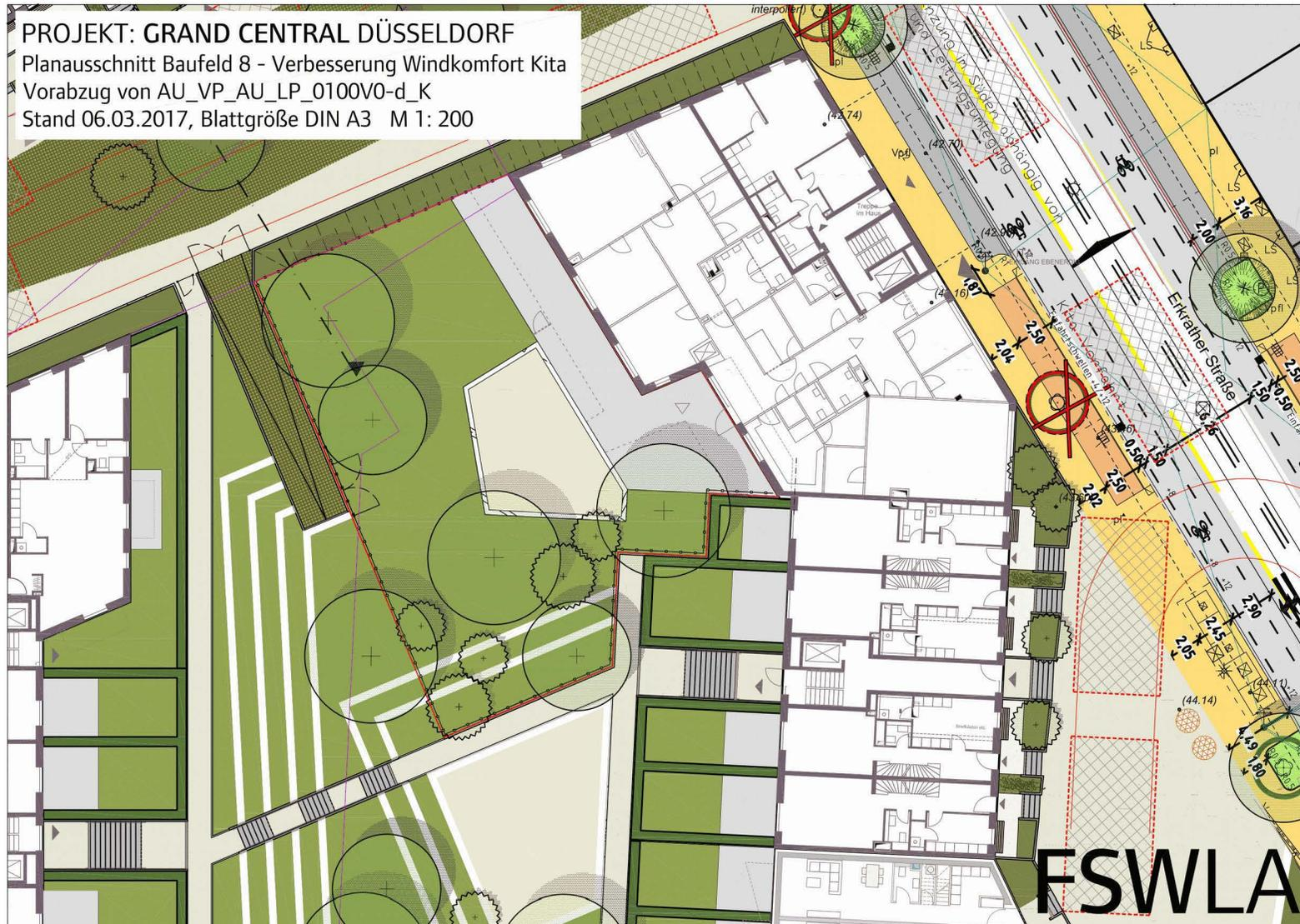
Lageplan mit Maßnahmen zur Verbesserung des Windkomforts im Eingangsbereich und auf den Balkonen von Bauteil 6
